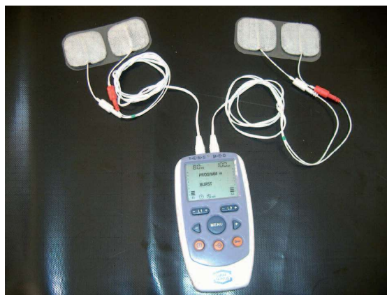
FIG. 3. Equipo Tensmed modelo 911 de la casa comercial Enraf-nonius, con electrodos autoadhesivos de silicona de 5 cm 2 .
