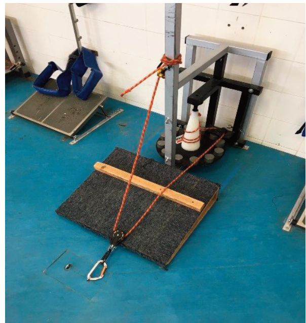
FIGURA 1. Sistema de resistencia isoinercial empleado.
